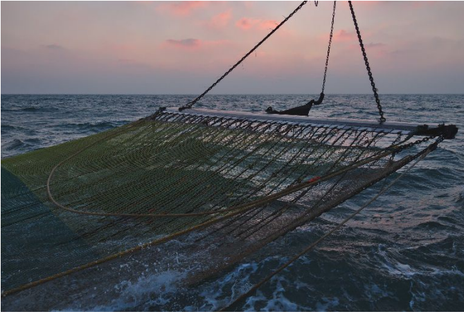
Het halen van het net (80mm pulsvisserij)
